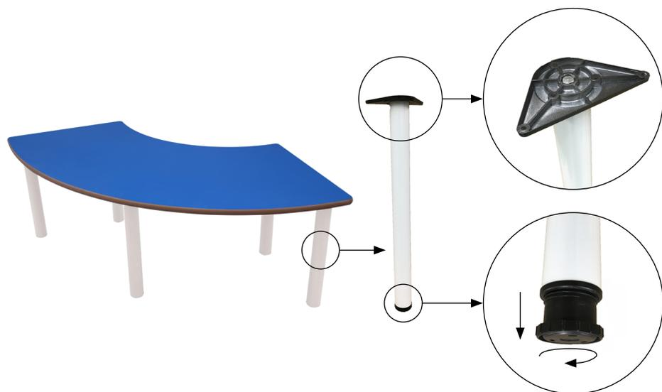
Mesa de adulto 1/4 de aro, compuesta por cinco patas de tubo metálico de Ø60 x 1,5 mm con acabado en pintura Epoxi y una tapa en tablero MDF laminado de 21 mm de espesor, con cantos redondeados y superficie y contratiro de laminado de alta presión (HPL). Incorpora conteras niveladoras para evitar que cojee. Acabado de estructura en pintura Epoxi. Íntegramente desmontable, reduciendo así el impacto ambiental en su transporte.
